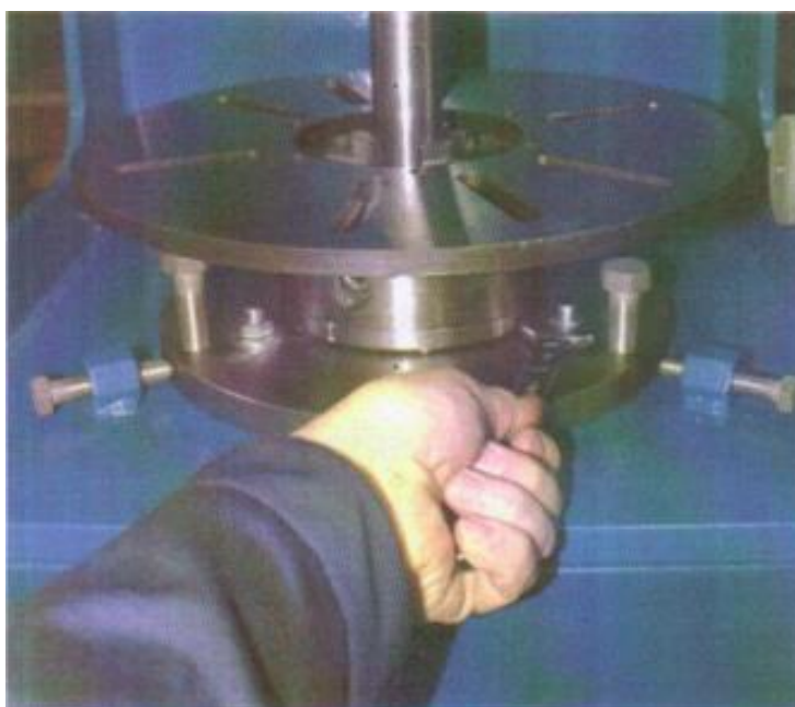
Рисунок 15 - Прижимные болты для фиксации настроек.
