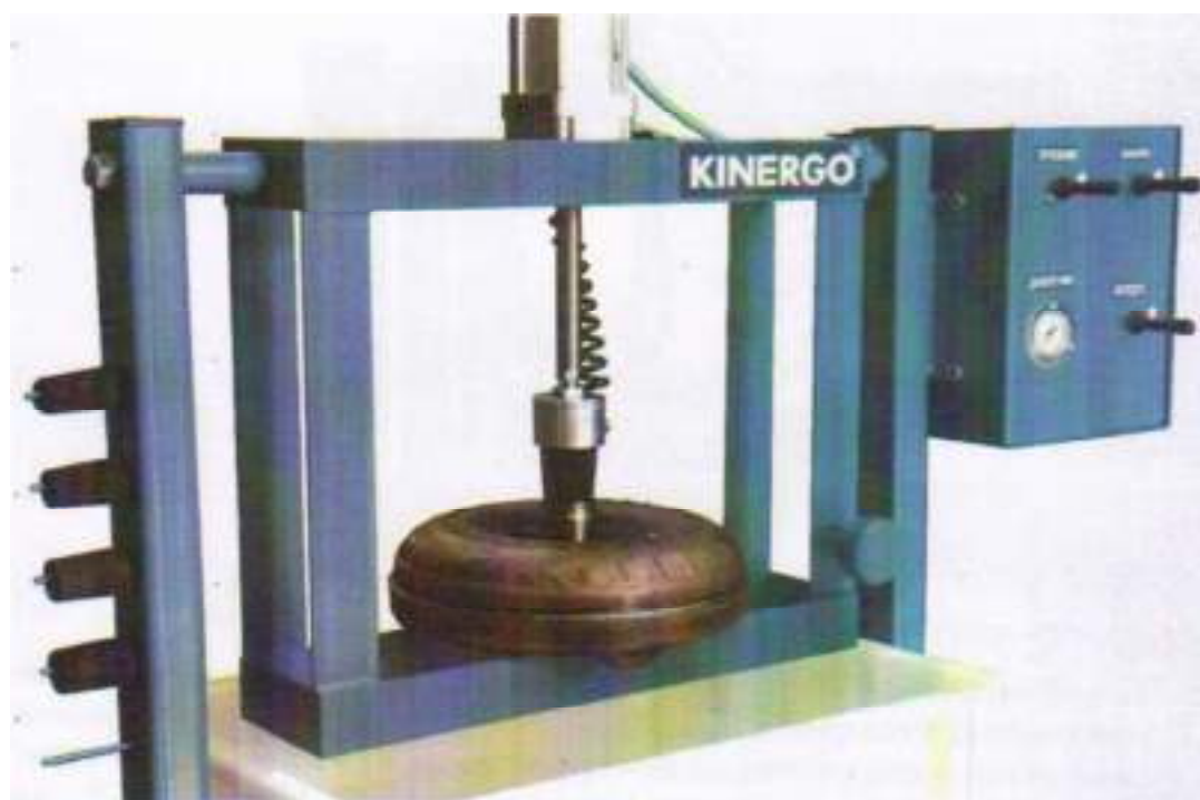
Рисунок 3 - Установка гидротрансформатора на основание.
