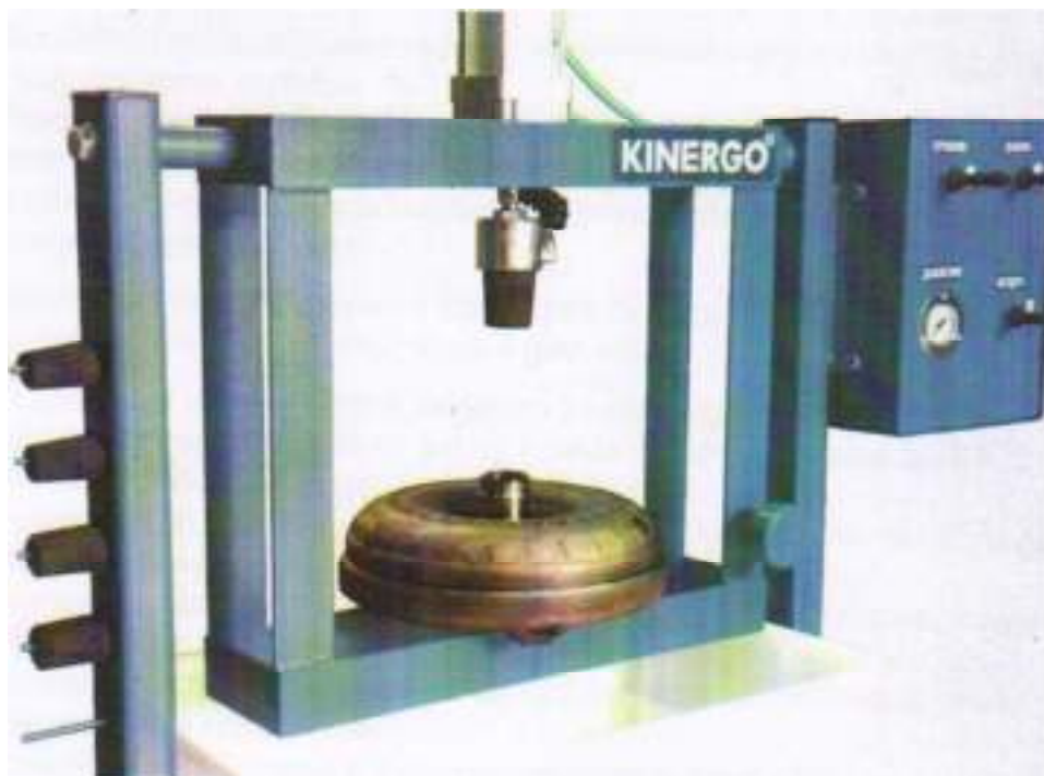
Рисунок 3 - Установка гидротрансформатора на основание.
