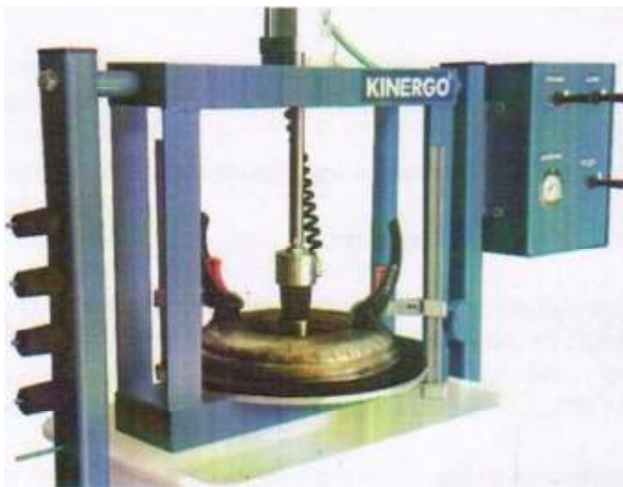
Рисунок 5 – Проверка герметичности соединения гидротрансформатора
