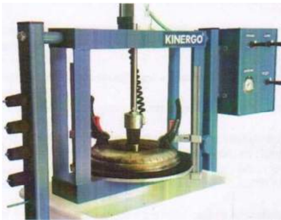
Рисунок 5 – Проверка герметичности соединения гидротрансформатора
