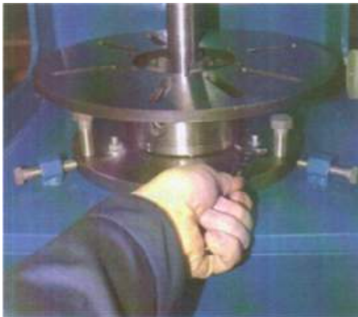
Рисунок 15 - Прижимные болты для фиксации настроек.
