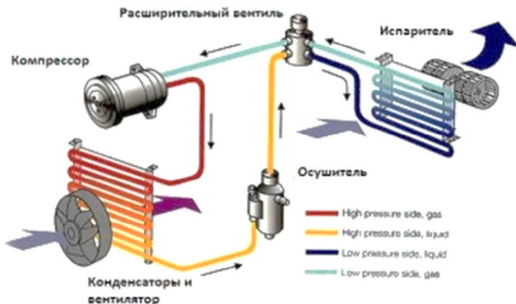
Рис. 3. Система кондиционирования.
