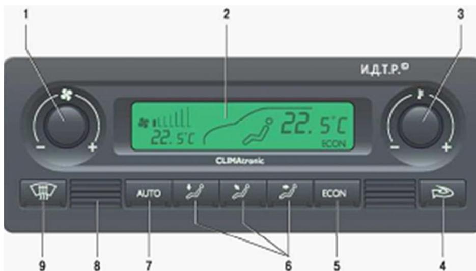
Рис. 5. Блок автоматического управления системой отопления(кондиционирования) и вентиляции салона: 1 - переключатель режимов работы электровентилятора воздухонагревателя; 2 - дисплей; 3 - регулятор температуры поступающего в салон воздуха; 4 - выключатель режима рециркуляции; 5 - выключатель кондиционера; 6 - переключатели распределения потоков воздуха; 7 - выключатель автоматического режима работы
