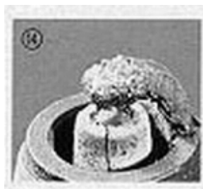
Рис. 14. Расплавленный центральный электрод.
