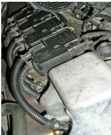
Рис. 17. Индивидуальное двойное дистанционное зажигание.
