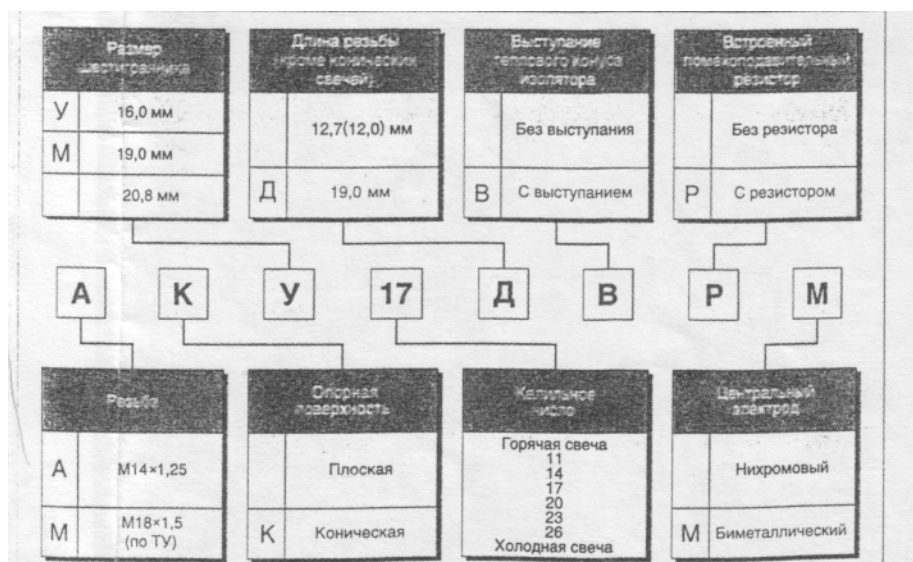
Рис. 4. Обозначение свечей зажигания
