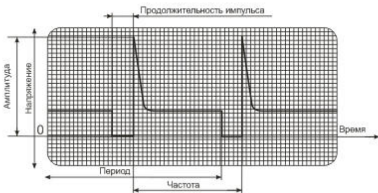
Рис. 21. «Образцовая» осциллограмма работы форсунки
