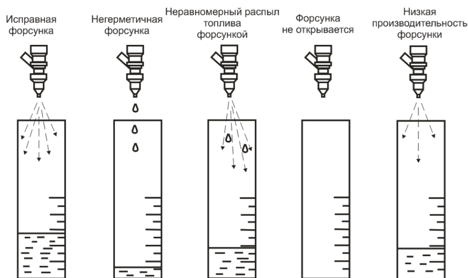
Рис. 27. Возможные варианты тестирования форсунок.
