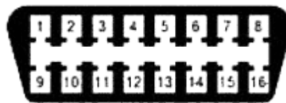
Рис. 6. Диагностический разъём OBD II: 1 OEM; 2 J1850 Шина+ (Bus + Line, SAE); 3 OEM; 4 Заземление кузова; 5 Сигнальное заземление; 6 Верхний контакт CAN (J-2284); 7 K Line ISO 9141-2; 8 OEM; 9 OEM; 10 Bus - Line, Sae J1850 Шина; 11 OEM; 12 OEM; 13 OEM; 14 Нижний контакт CAN (J-2284); 15 L Line ISO 9141-2; 16 Напряжение АКБ.
