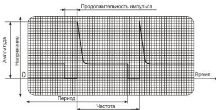
Рис. 21. «Образцовая» осциллограмма работы форсунки
