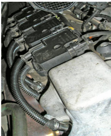
Рис. 17. Индивидуальное двойное дистанционное зажигание.
