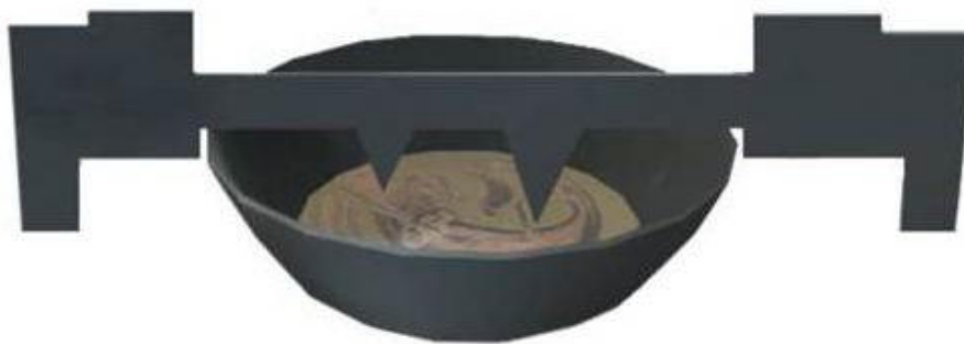
Рис. 4.1. Измерение уровня масла шаблоном
