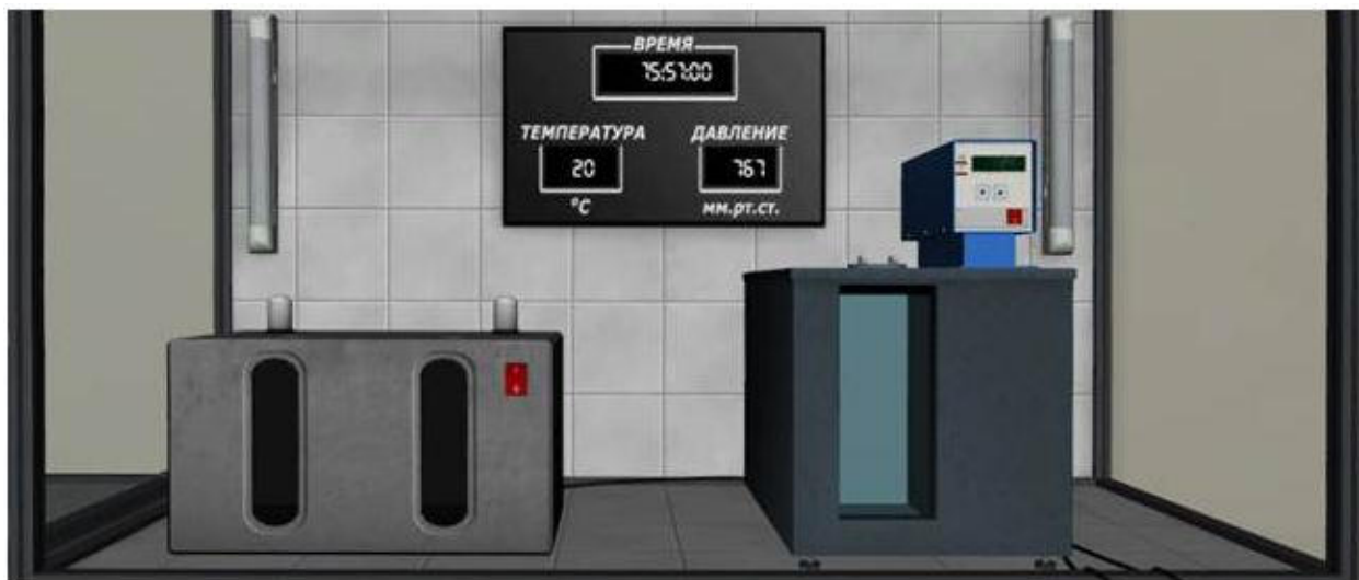
Рис. 3.4. Прибор с зеркальным отражением света и термостат (прибор для охлаждения топлива)
