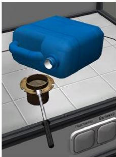
Рис. 4.3. Взятие образца топлива
