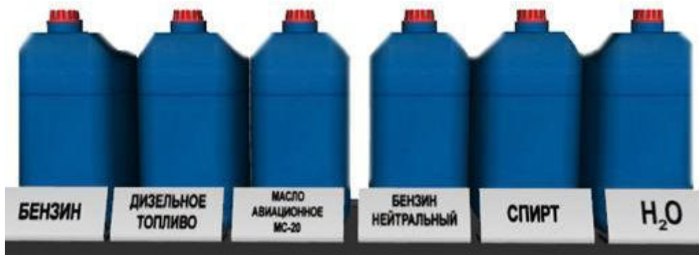
Рис. 3.4. Канистры с испытуемым топливом, спиртом и дистиллированной водой На столе располагаются две колбы для испытуемого топлива и дистиллированной воды, закрытые пробками, с отверстиями, в которые вставлены термометры, градуированные от 0 до 100 0 С.
