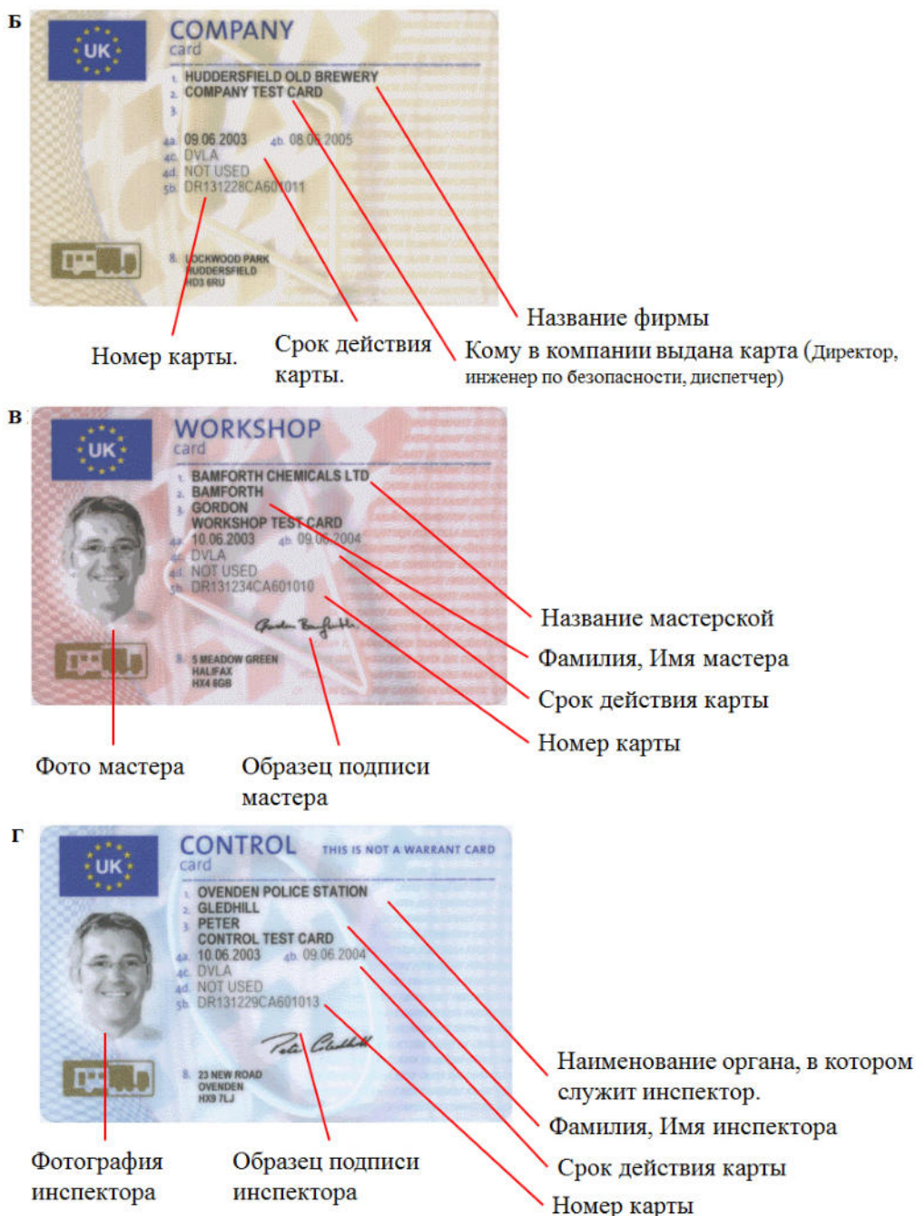
Рис. 6.4. Типовые виды чип-карт:
