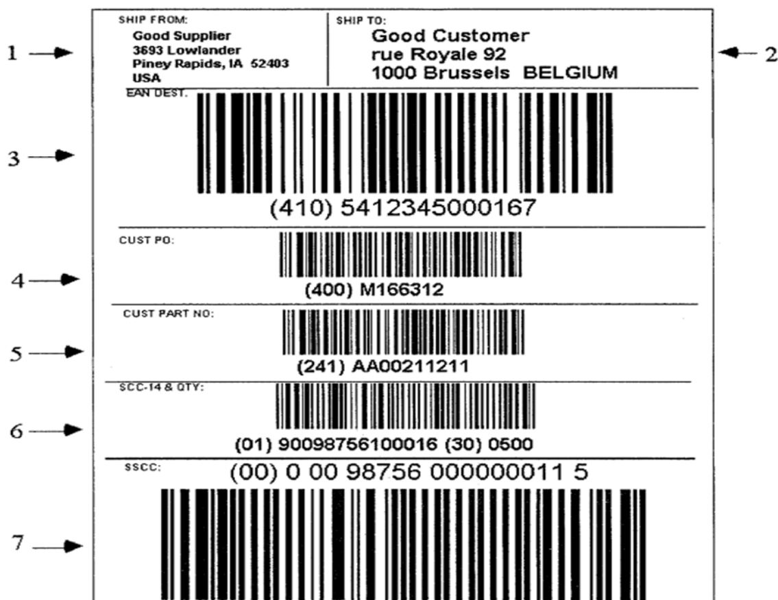
Рис. 2.12. Расширенная этикетка с идентификатором UCC/EAN: 1 – текстовая информация об отправителе; 2 – текстовая информация о получателе; 3 – ссылка к базе данных перевозчика; 4 – ссылка к базе данных получателя; 5, 6 – дополнительные данные (241 – номер, присвоенный получателем), 01 – глобальный номер товара EAN, 30 – количество); 7 – уникальный идентификатор транспортируемой единицы в символике UCC/EAN-128.
