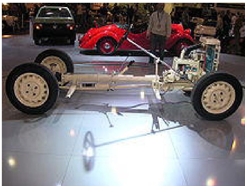
Рис.7.3. Рама довоенного автомобиля «Шкода» с подмоторной вилкой в передней части
