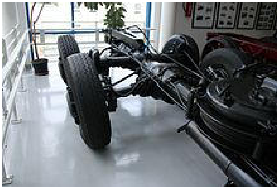
Рис.7.2. Хребтовая рама грузовика «Татра»
