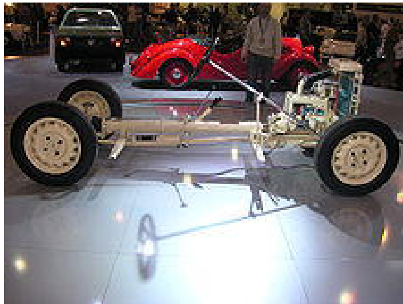
Рис.7.3. Рама довоенного автомобиля «Шкода» с подмоторной вилкой в передней части
