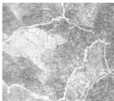
Рис. 5. Заэвтектоидная сталь с 1,2% С – перлит и цементит вторичный (×500).
