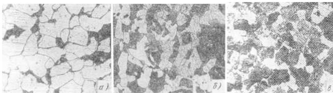
Рис.4. Доэвтектоидные стали – феррит и перлит ( \times 500 ): а – 0,2% С, б – 0,4% С, в – 0,6% С.
