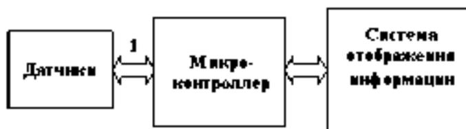
Рис. 4. Структура автономной контрольно-измерительной системы.
