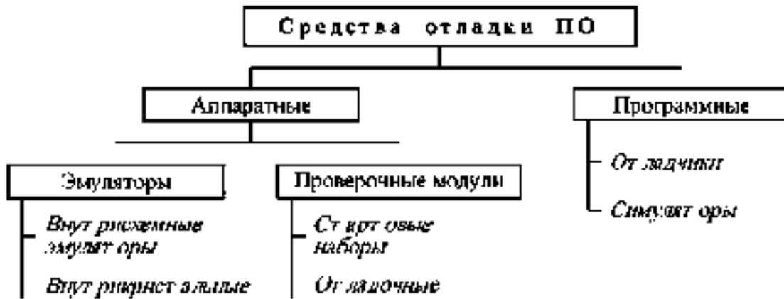
К аппаратным средствам отладки относятся аппаратные эмуляторы и проверочные модули.
