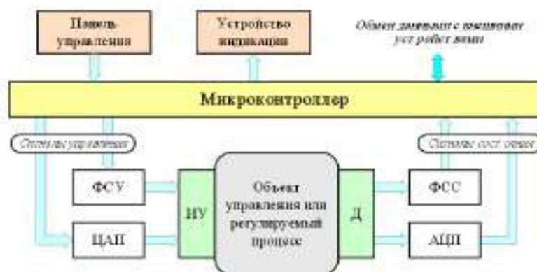
Рис. 1. Типовая структура системы управления на основе микроконтроллера
