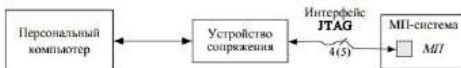
Такой способ отладки также называют сканирующей эмуляцией. Достоинствами этого способа является возможность выполнения различных действий на процессоре без его изъятия из системы, использование малого числа выводов процессора и поддержка его максимальной производительности без изменения электрических характеристик системы.
