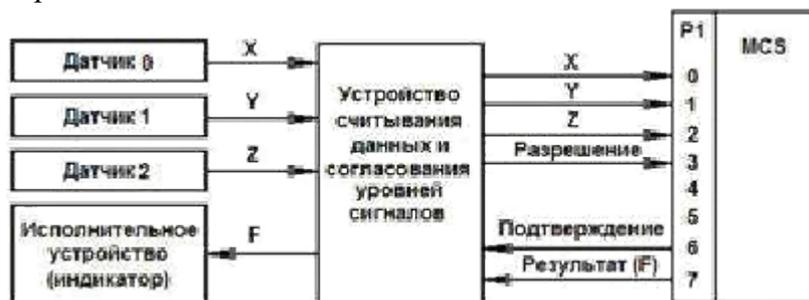
Рис. 26.1. Структурная схема микропроцессорной системы обработки битовой информации
