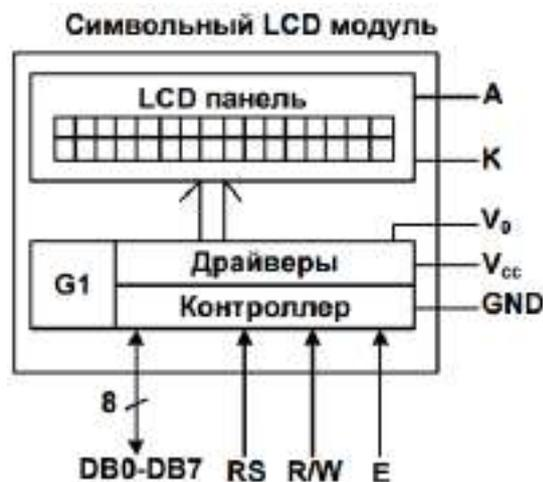
Электрический интерфейс ЖКИ состоит из 3-х шин: шины данных (DB0...DB7), шины управления (RS, R/W, E) и шины питания (Vss, Vdd, Vee). Выполняемые функции каждого вывода ЖКИ приведено в таблице 11.
