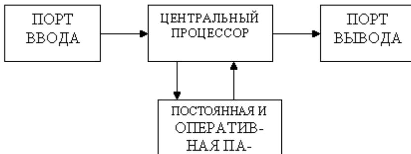
Как работает архитектура? МП контролирует все устройства и управляет ими посредством линий управления и контроля. Адресная шина (ША) однонаправленная выбирает ячейки памяти данных, команды, порты ввода или вывода данных.
