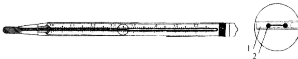
**Рис. 1.1.** Спиртовой минимальный термометр:
