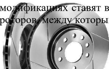
лучшего охлаждения. Чем больше диаметр тормозных дисков, тем больший тормозной момент они могут создать. Тюнинговые диски обычно имеют увеличенный диаметр по сравнению с серийными.
