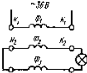
Рис. 55. Схема неправильного соединения второй и третьей фаз обмоток статора (лампа не горит)
