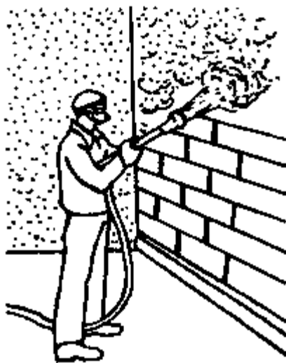
Рисунок 5 - Последовательное нанесение слоев обрызга, грунта
