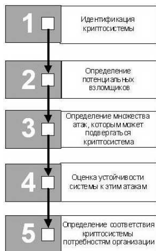
Рис. 7.2. Процесс оценки эффективности криптографической защиты Моделирование угроз безопасности информационных ресурсов
