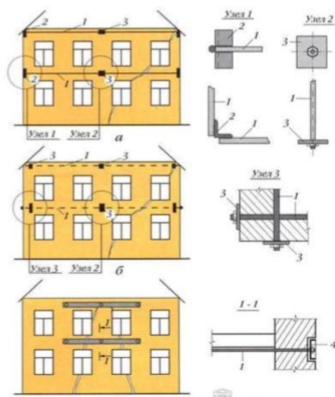
Рисунок 1. Усиление стен: а, б -стальными тяжами с наружной (а) и внутренней (б) сторон здания; в -установкой ненапрягаемых тяжей; 1 -тяж; 2 -уголок; 3 -опорная стальная пластинка; 4 -швеллер
