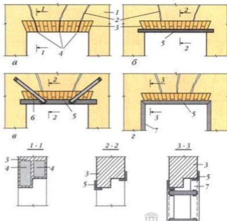
Рисунок 3. Усиление кирпичных перемычек: а -расклинивание трещин стальными пластинами; б, в -стальными уголками при небольшом (б) и длинном (в) пролетах; г -стальными уголками, соединенными со стальной обоймой простенков; 1 - трещина; 3 -перемычка; 4 -стальныепластины-клинья; 5 -стальной уголок; 6 -тяги из полосовой стали; 7 -стальная обойма простенка
