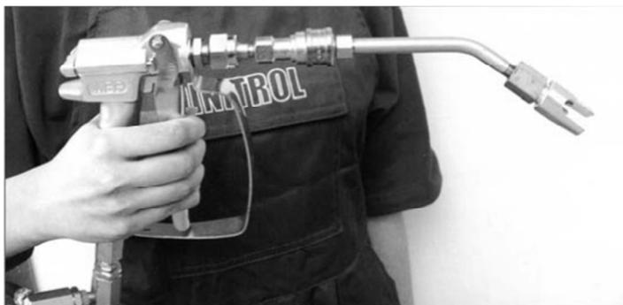
Рис. 21. Пистолет для безвоздушного распыления
