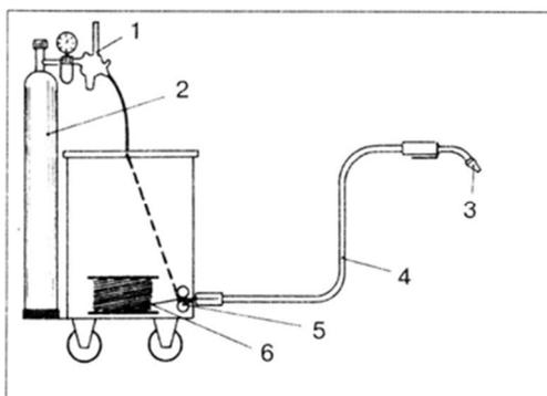
Рис. 10. Схема аппарата для сварки в среде защитного газа: 1 – редуктор; 2 – газовый баллон; 3 – горелка; 4 – направляющий шлаг; 5 –
