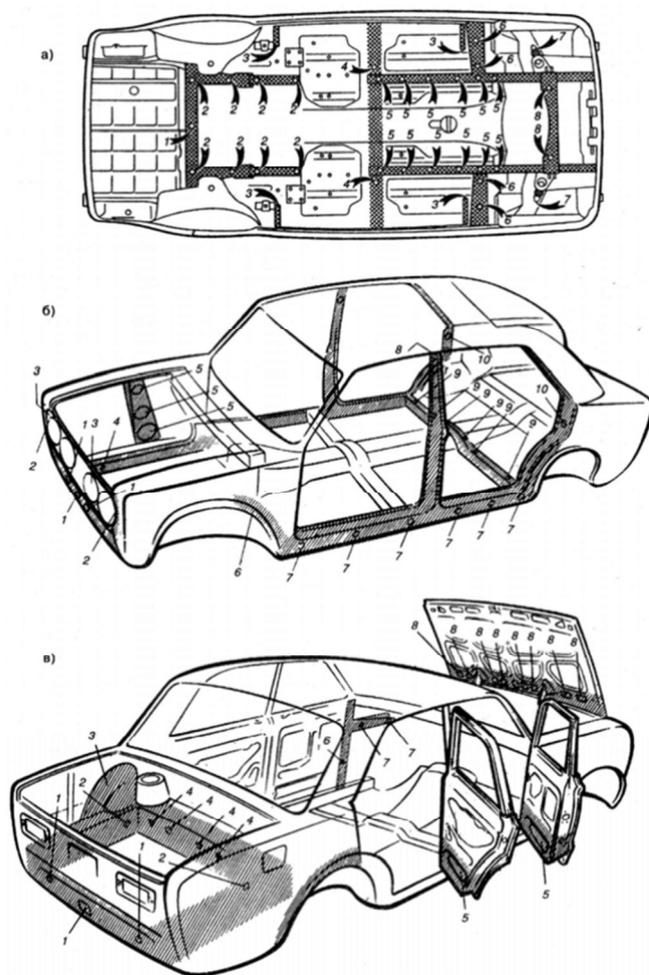
Рис. 19. Скрытые полости кузова автомобиля ВАЗ-2106:
