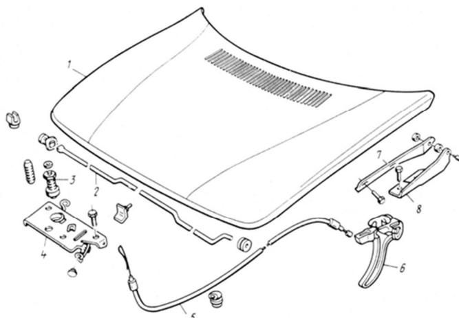
Рис. 19. Капот двигателя автомобиля с механизмом открывания:
