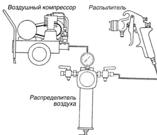
Рис. 16. Установка для нанесения лакокрасочных материалов распылением
