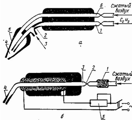
Рис. 2. Схема горелок для сварки термопластов горячими газами:
