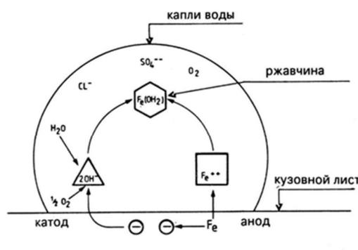
Рис. 18. Схематичное изображение процесса коррозии
