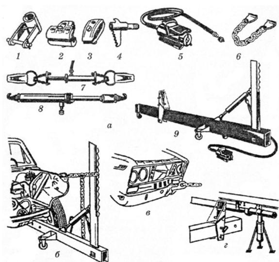
Рис. 17. Приспособления для выполнения правки деформированного участка кузова:
