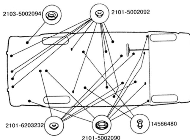
Рис. 22. Схема установки заглушек на кузове ВАЗ-2106
