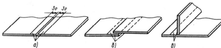
Рис. 4. Подготовка кромок к пайке латунным припоем:
