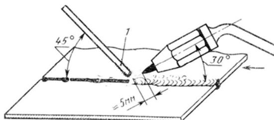
Рис. 5. Расположение горелки и припоя при пайке латунным припоем:
