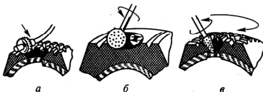
Рис. 5.2. Способы шероховки поврежденных мест покрышки:
