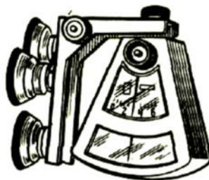
Рис. 1 - Деселерометр маятникового типа
