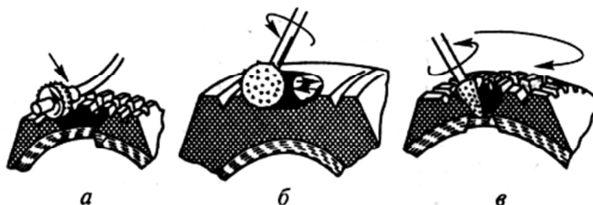
Рис. 5.2. Способы шероховки поврежденных мест покрышки:
