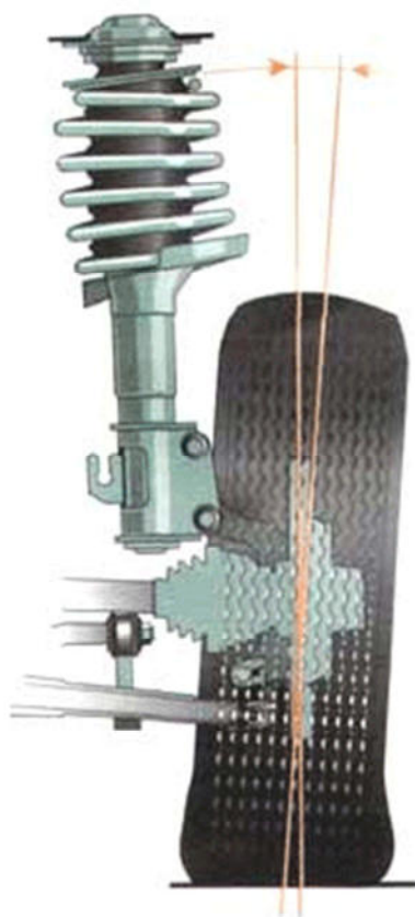
Рис. 2. Угол развала колеса.
