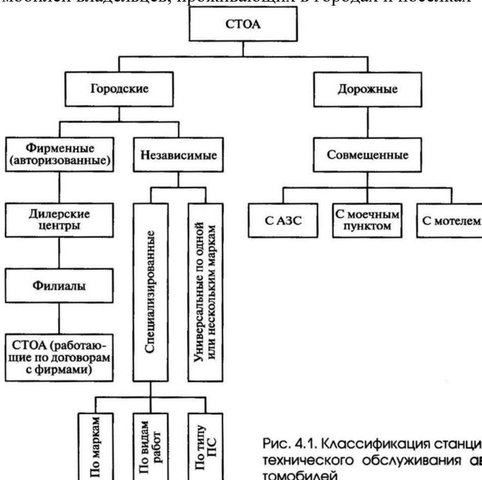
Рис. 4.1. Классификация станций технического обслуживания автомобилей
