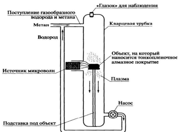
Рис. 3.6. Схема установки для нанесения алмазных пленок
