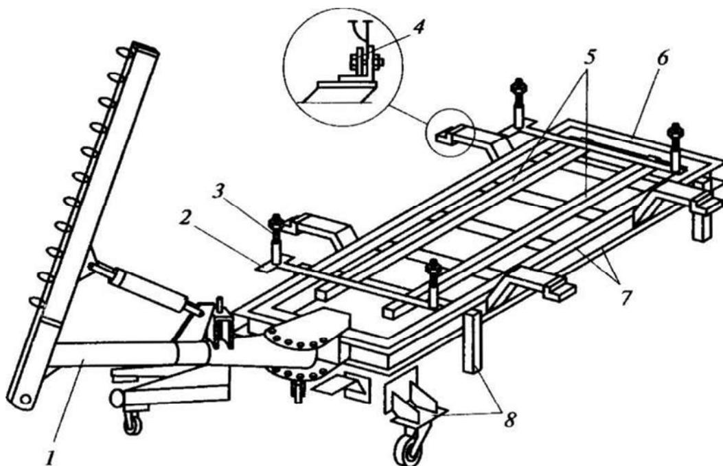
Рис. 5.27. Стенд для правки и контроля фирмы «Каролинер»:
