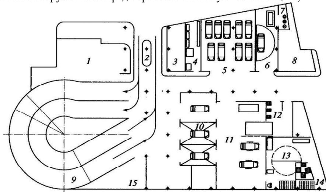
Рис. 4.10. Планировка первого этажа автостоянки на 290 автомобиле-мест:
