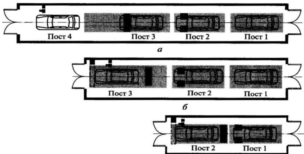
Рис. 4.7. Типовые планировочные решения ГУП «МГСТК» для проверки легковых автомобилей:
