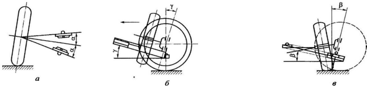
Рис. 5.23. Схемы определения углов установки управляемых колес: а — угла развала  $\alpha$ , б — угла продольного наклона оси поворота колеса  $\gamma$ ; в — угла поперечного наклона оси колеса  $\beta$ .
