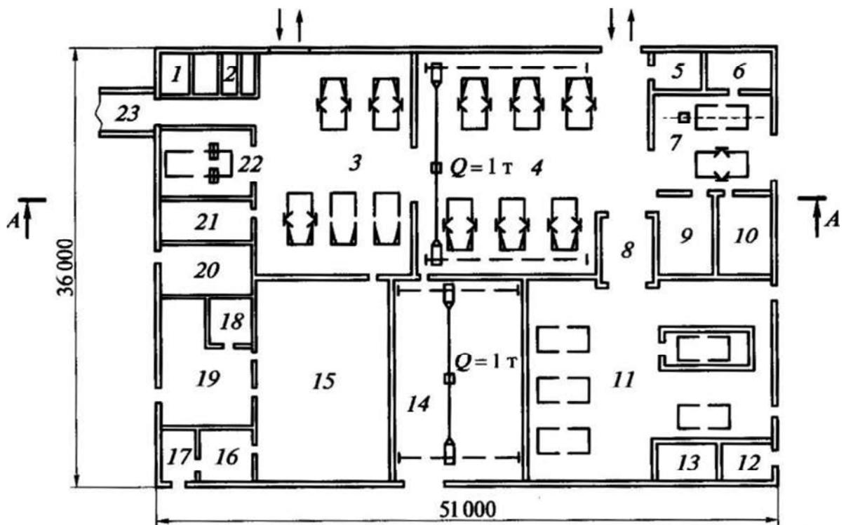
рис. 4.2. Планировка производственного корпуса станции технического обслуживания на 10 рабочих постов:
