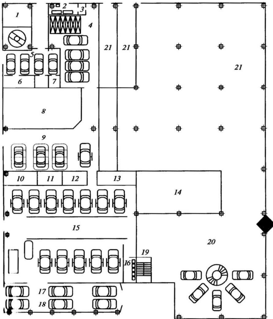
Рис. 4 4. Планировка дилерской СТОА на 35 рабочих постов:
