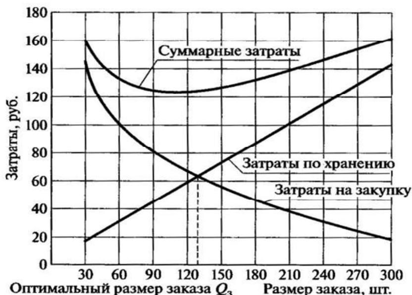
Рис. 9.4. График для определения оптимального размера заказа запчастей
