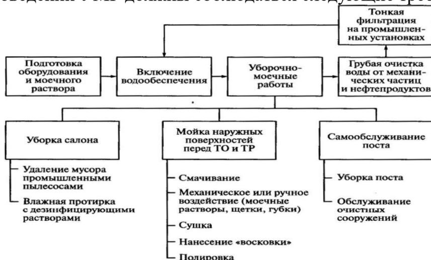
Рис. 6.2. Структура комплекса уборочно-моечных работ
