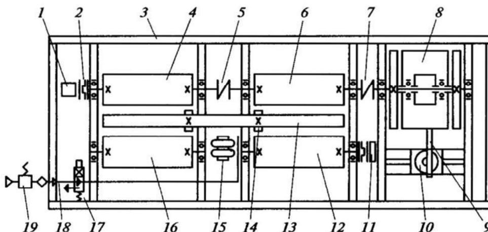
Рис. 5.20. Пневмокинематическая схема динамометрического стенда с электрическим тормозом:
