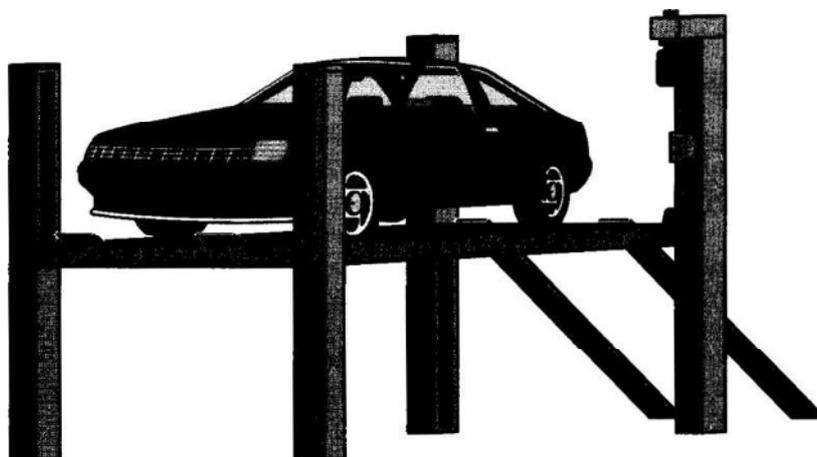
Рис. 5.11. Четырехстоечный платформенный подъемник
