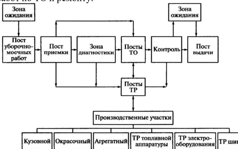
Рис. 7.2. Функциональная схема СТОА
