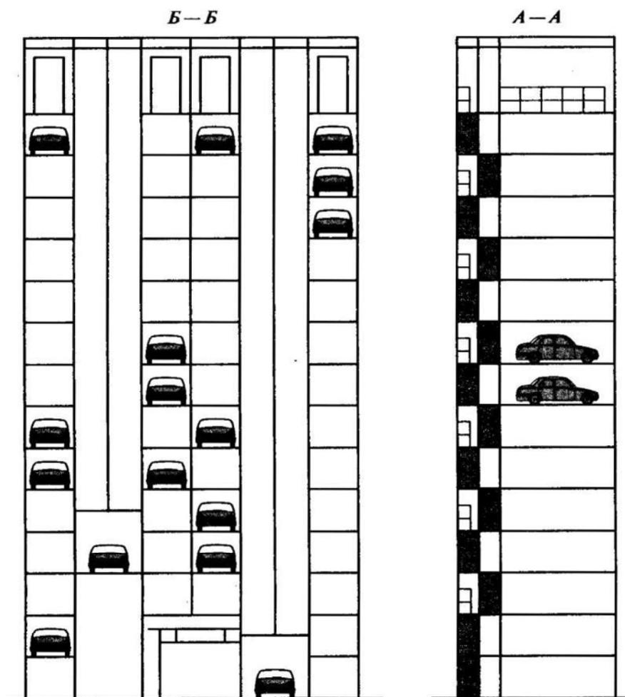
Подъемник-манипулятор, обеспечивающий подъем и установку автомобиля в соответствующую ячейку, управляется автоматизированной системой. Подъемник может также работать от внешнего компьютера с индивидуальной карточкой абонента. Среднее время установки-выдачи составляет 47 с.
