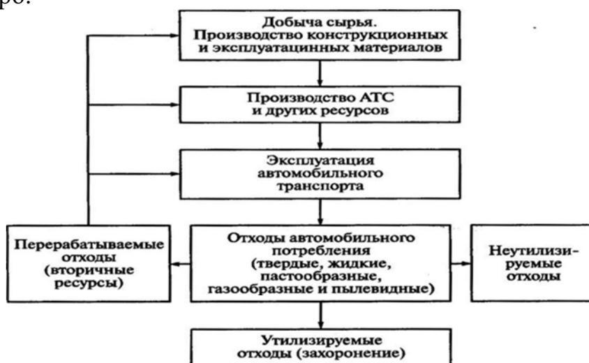
Рис. 9.9. Схема потребления ресурсов на автомобильном транспорте
