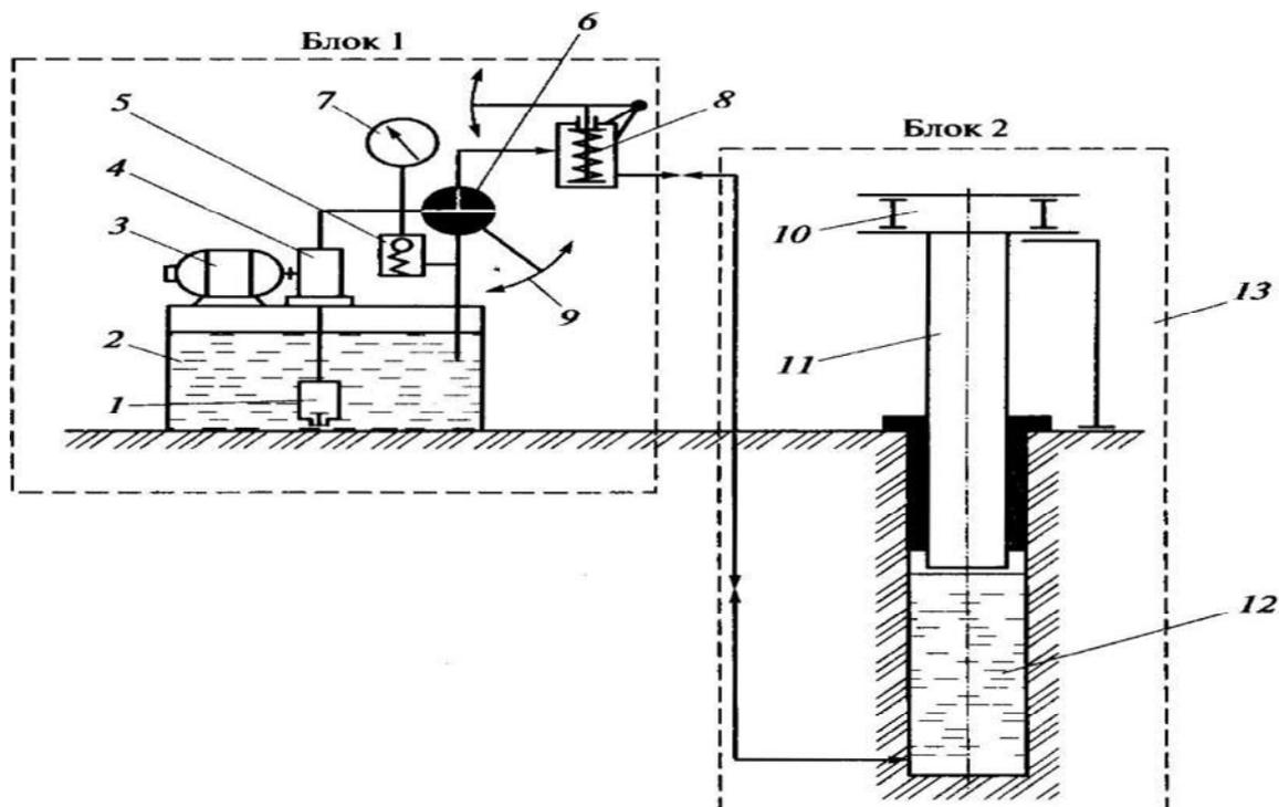
Рис. 5.9. Схема одноплунжерного электрогидравлического подъемника:
