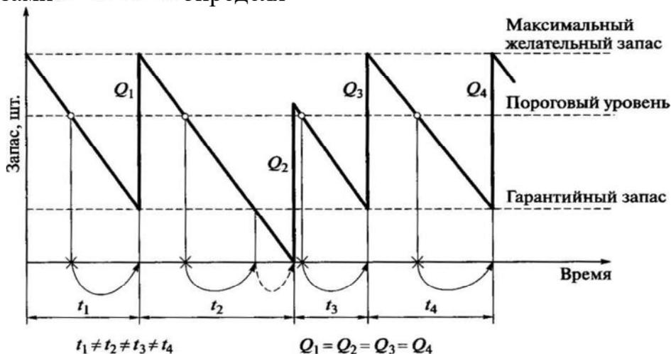
Рис. 9.5. График движения запасов деталей в системе управления с постоянным размером заказа:
