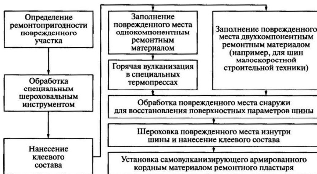
Рис. 6.8. Основные этапы ремонта сквозных повреждений шин
