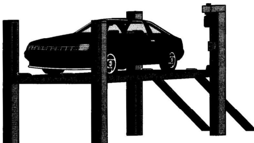
Рис. 5.11. Четырехстоечный платформенный подъемник
