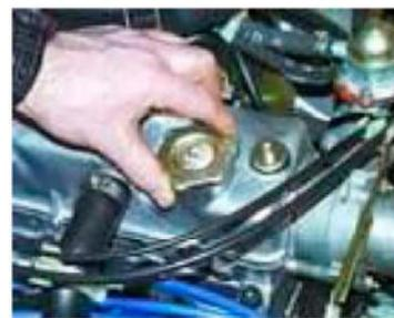
Рис. 17. Маслозаливная крышка
