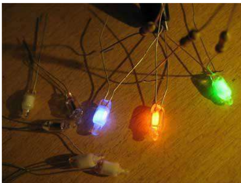
Рисунок 3. Внешний вид газоразрядного индикатора в момент свечения
