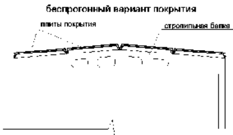
Рисунок 1–беспрогонный вариант покрытия
