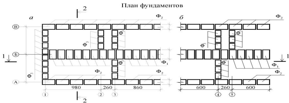
Рис. 1. Планы фундаментов и раскладки плит перекрытия над подвалом: l_1 a – для торцевой блок-секции; b – для рядовой блок-секции
