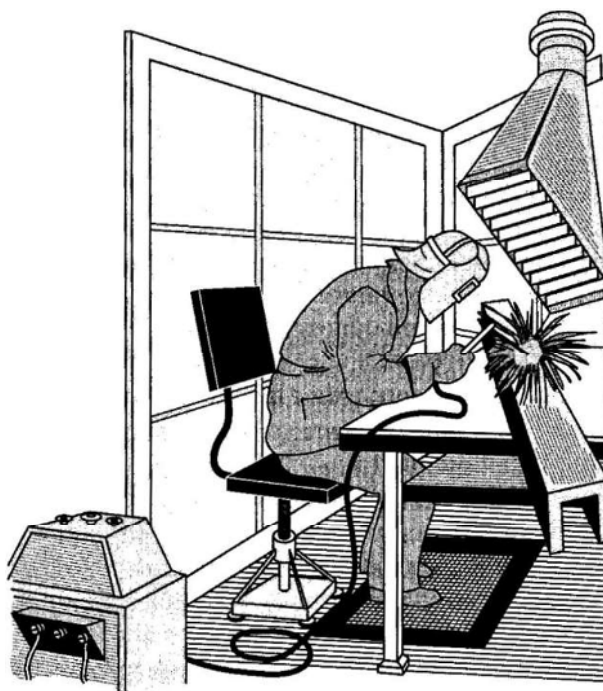
Рис. 6.1. Рабочее место электросварщика
