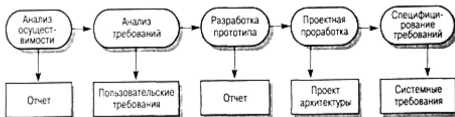
Рисунок 3.1 - Этапы процесса разработки спецификации
