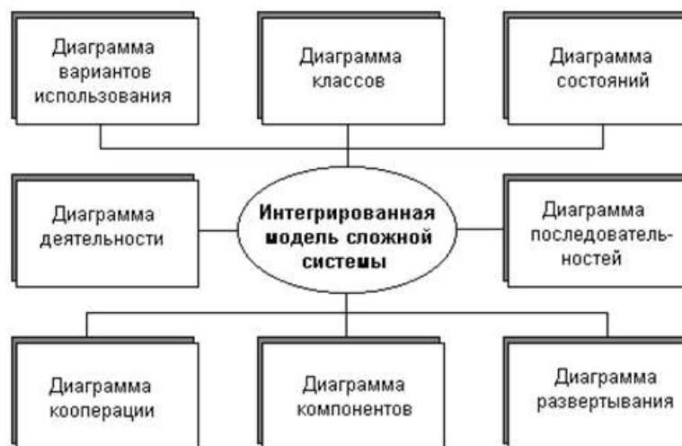
Рисунок 2.1 - Интегрированная модель сложной системы в нотации языка UML
