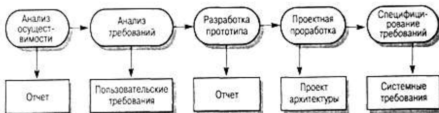
Рисунок 3.1 - Этапы процесса разработки спецификации
