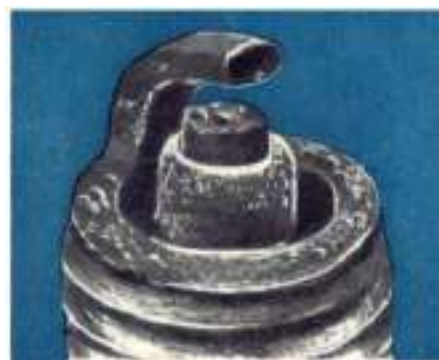
г - замасленная свеча
