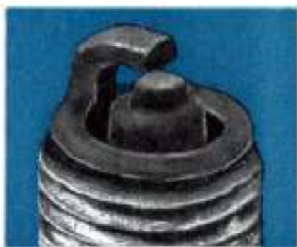
в - закопченная свеча
