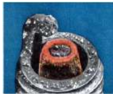
г - замасленная свеча
