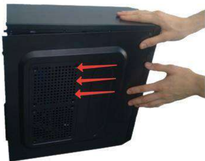
Снимаем крышку системного блока компьютера
