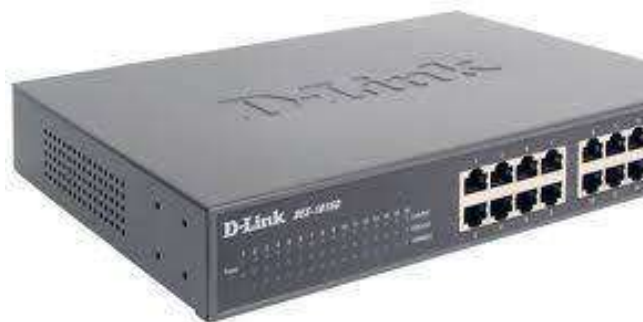
Рис. 7. Концентратор с фиксированным количеством портов
