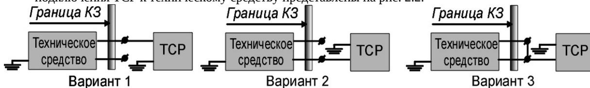
Рис. 2.2. Варианты подключения с использованием цепи Пикара
