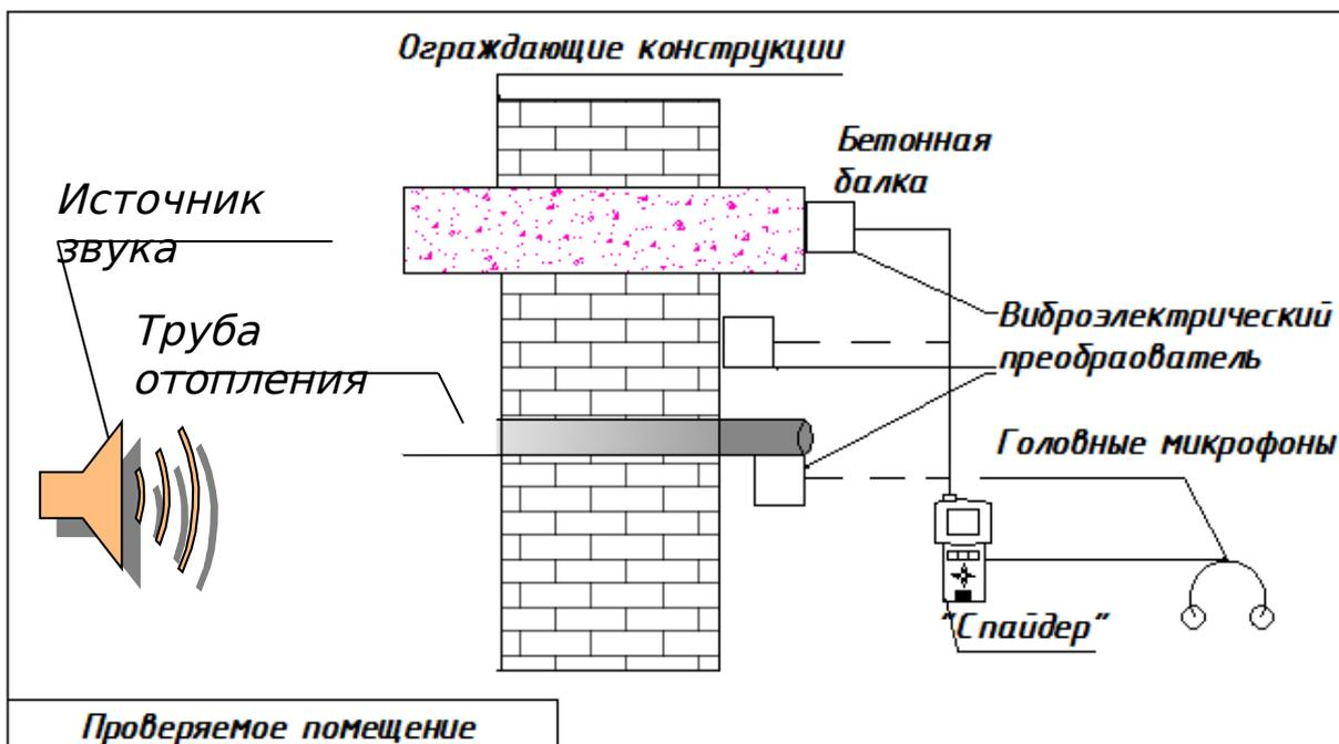
Рисунок 3.5 - Выявление виброакустических утечек информации с помощью многофункционального поискового прибора «Спайдер».
