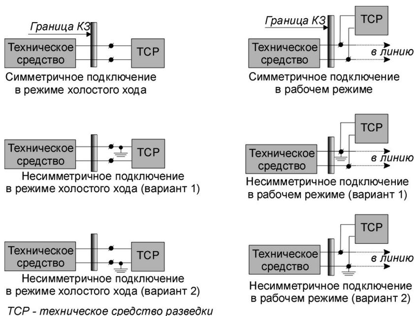
Рис. А2.1. Варианты подключения к сигнальной двухпроводной линии
