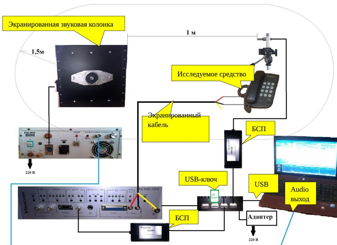
Рис. А1.3. Схема измерительного стенда
