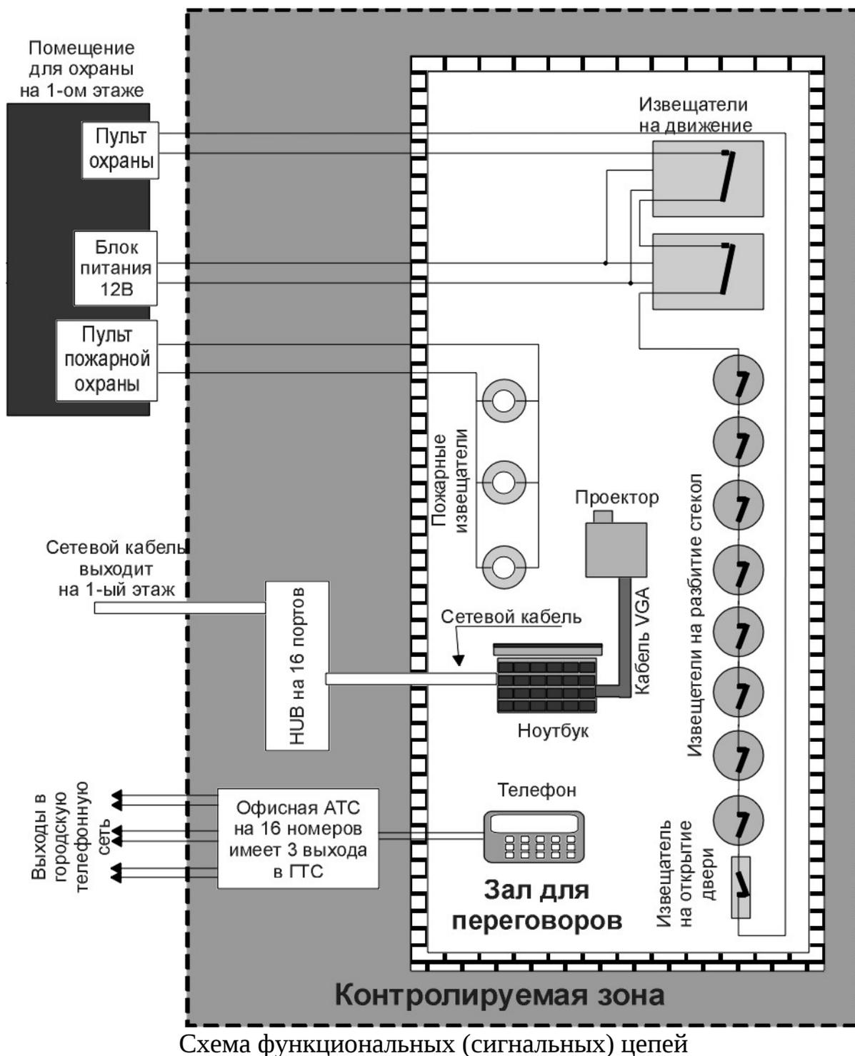
Система охранной сигнализации помещения замыкается на один шлейф и выходит в помещение охраны на 1-м этаже. Извещатели на движение питаются постоянным напряжением 12В. Бесперебойный источник питания находится в помещении охраны на 1-м этаже.
