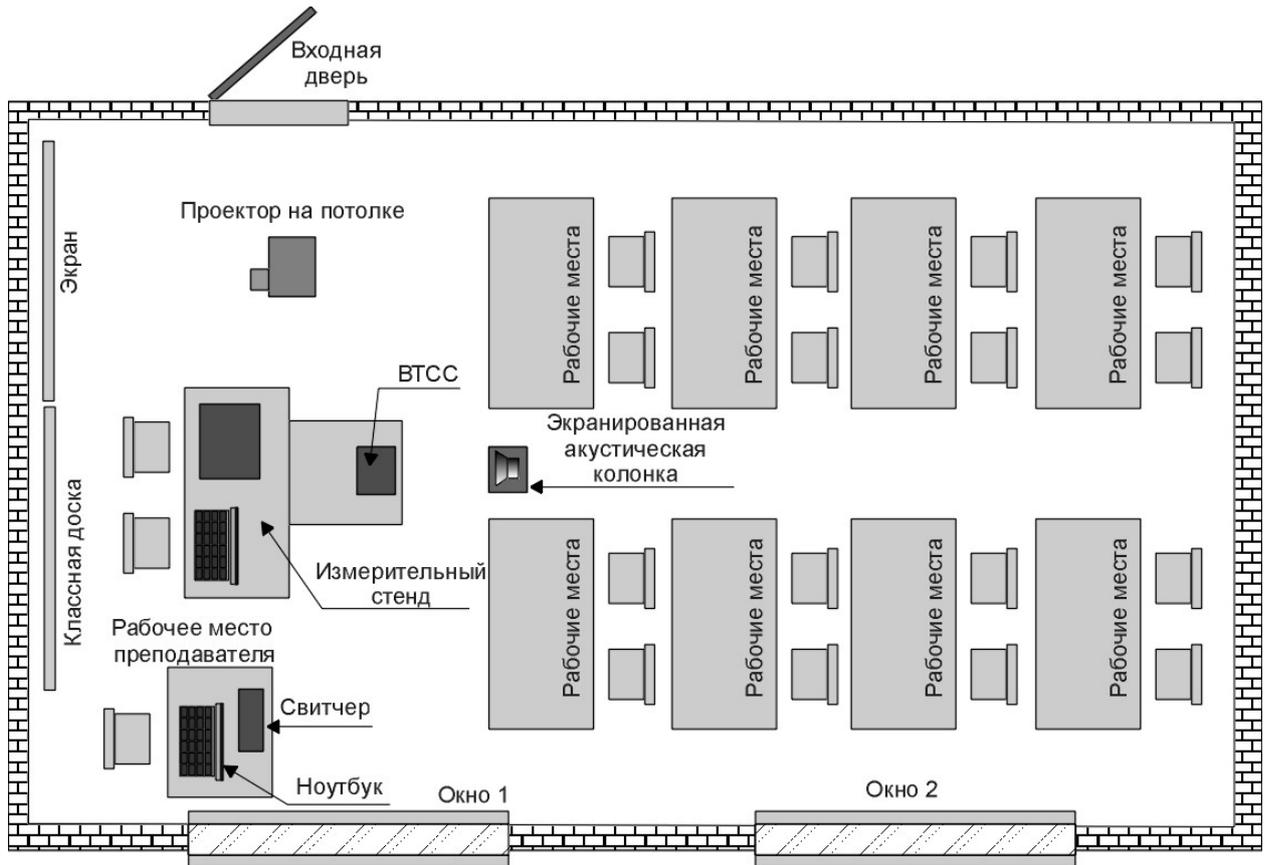
Рис. А1.1. Общий план лаборатории АВАК и НЧ АЭП (вариант)
