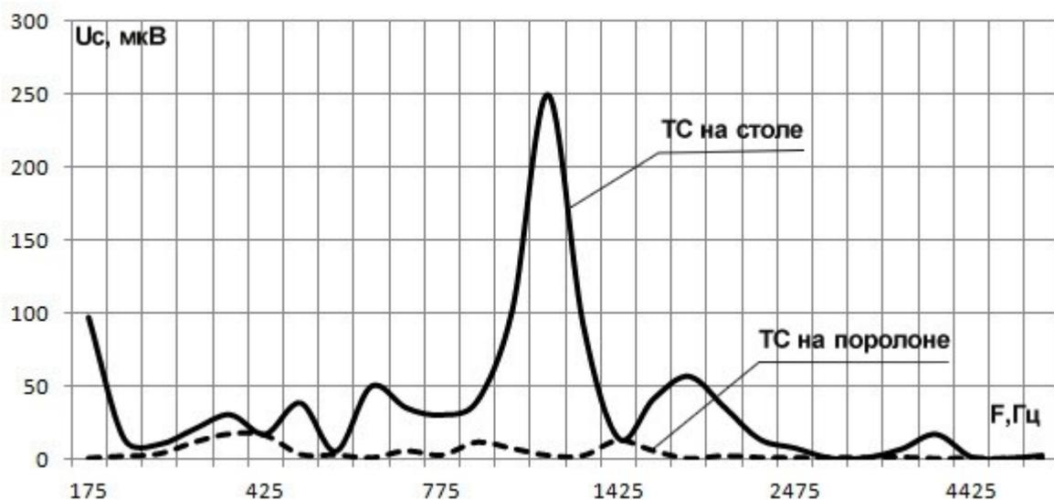
Рис. 2.6. Информативный сигнал в различных положениях технического средства
