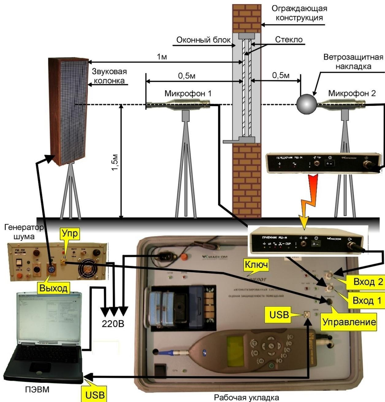
Рис. 2. Сборка системы для проведения акустических измерений
