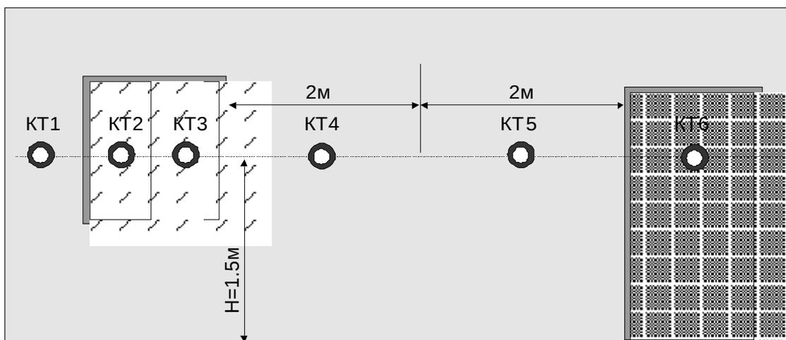
Рисунок 2.2 - Размещение КТ на вертикальных ограждающих конструкциях
