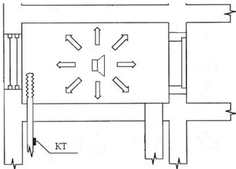
Рисунок 3.4 - Размещение контрольных точек на системе отопления для вибрационных измерений
