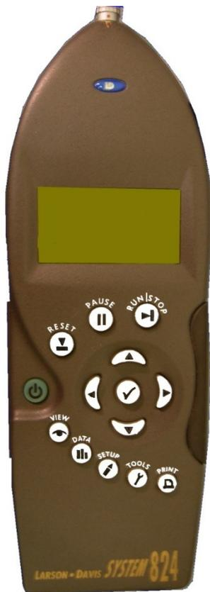
Рис. 31. Внешний вид шумомера
