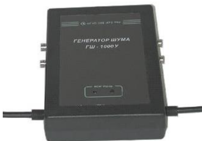
Рисунок 3.6 – внешний вид генератора шума ГШ-1000У
