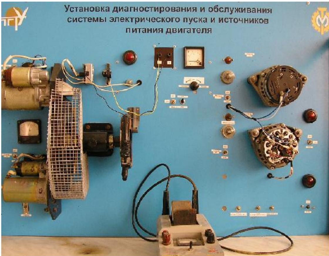
Рис. 7. Общий вид лабораторной установки для испытания генераторов
