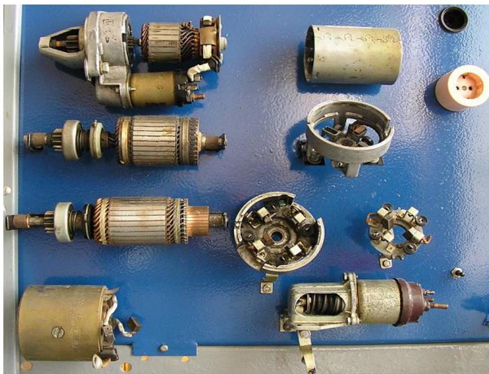
Рис. 21. Лабораторная установка для диагностирования элементов стартерных установок
