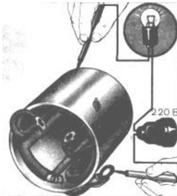
Рис. 24. Испытание обмоток возбуждения на замыкание с корпусом.
