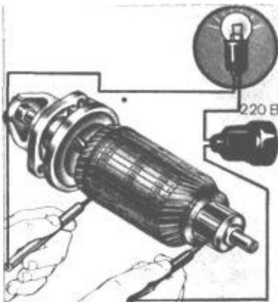
Рис. 25. Испытание обмоток ротора на замыкание с корпусом.
