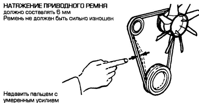
Рис 1. Проверка натяжного ремня.
