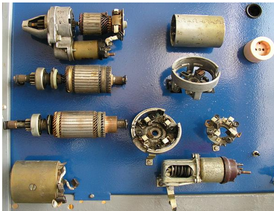
Рис. 4. Лабораторная установка для диагностирования элементов стартерных установок
