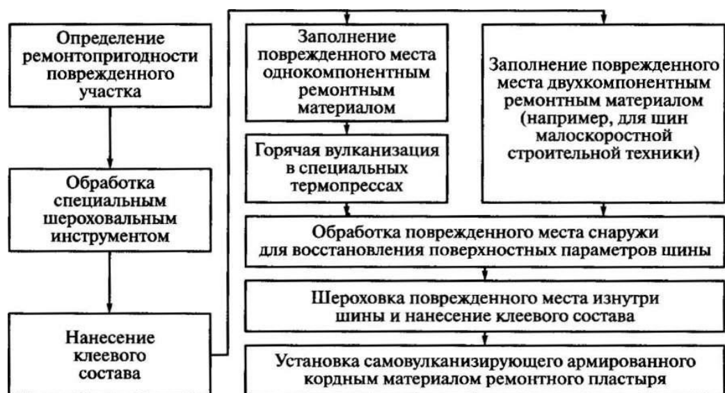
Рис. 6.8. Основные этапы ремонта сквозных повреждений шин
