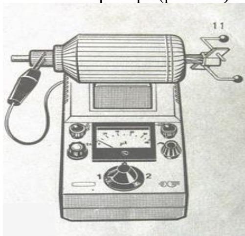
Рис.10. Проверка ротора на наличие межвиткового замыкания.
