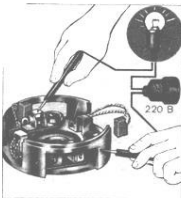
Рис. 6. Проверка изоляции щеткодержателей
