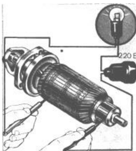
Рис. 8. Испытание обмоток ротора на замыкание с корпусом.
