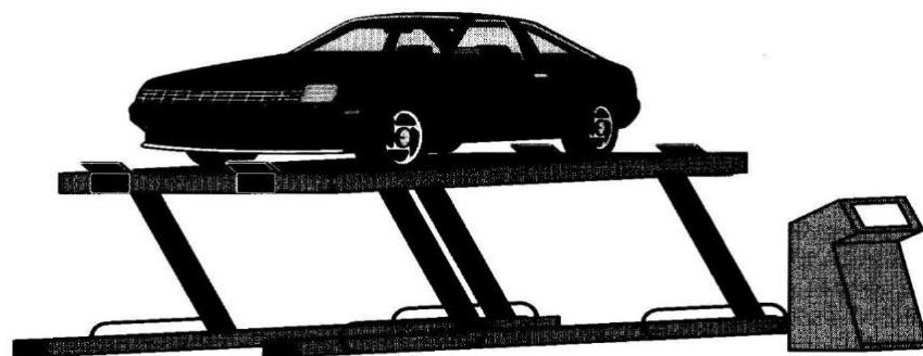
Рис. 5.12. Параллелограммный подъемник для легковых автомобилей
