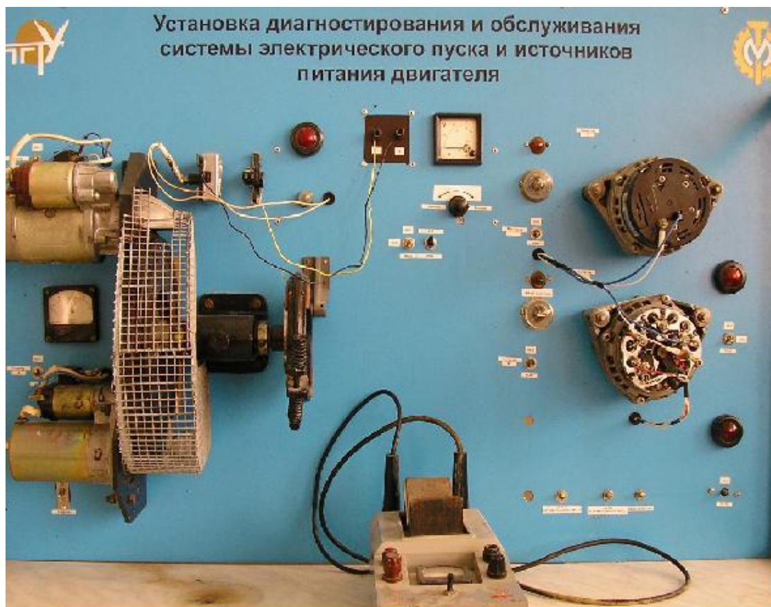
Рис. 2. Общий вид лабораторной установки для испытания генераторов
