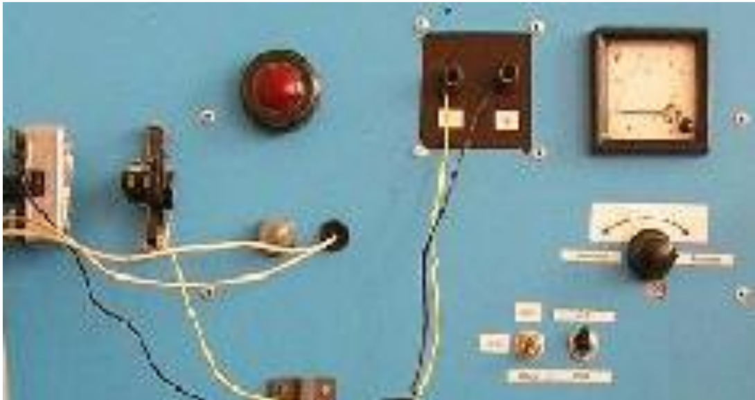
Рис. 4. Общий вид лабораторной установки для испытания регуляторов напряжения
