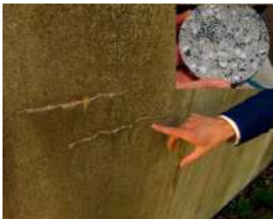
Рисунок 4. Новый стройматериал - самовосстанавливающийся бетон
