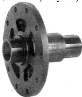
Рисунок. 1 Тюнинговая «катушка», напрямую соединяющая ведущие валы (полуоси)
