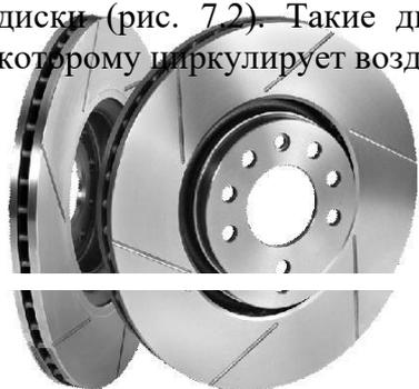
лучшего охлаждения. Чем больше диаметр тормозных дисков, тем больший тормозной момент они могут создать. Тюнинговые диски обычно имеют увеличенный диаметр по сравнению с серийными.
