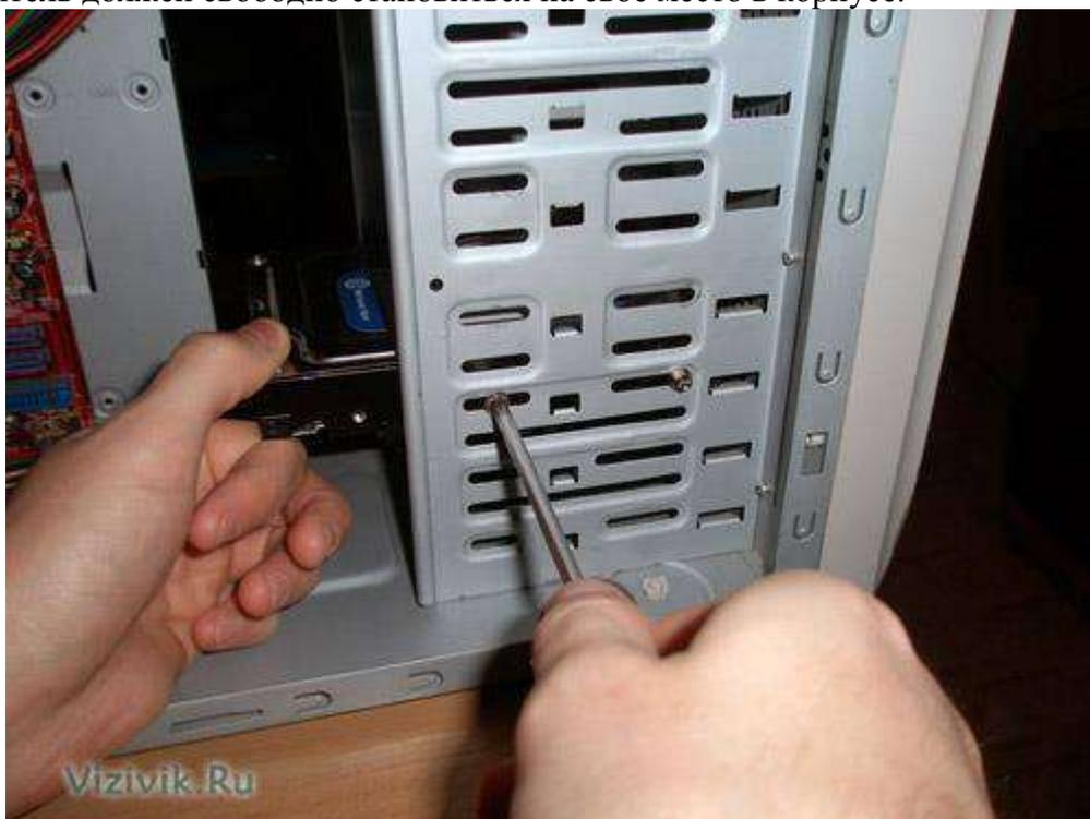
УСТАНОВКА ЖЕСТКОГО ДИСКА В ОТСЕК КОРПУСА
