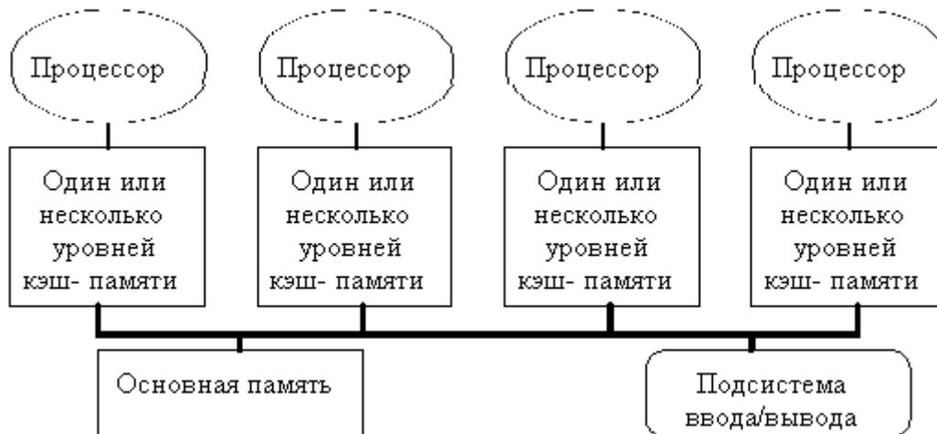
Рис. 1. Типовая архитектура мультипроцессорной системы с общей памятью.
