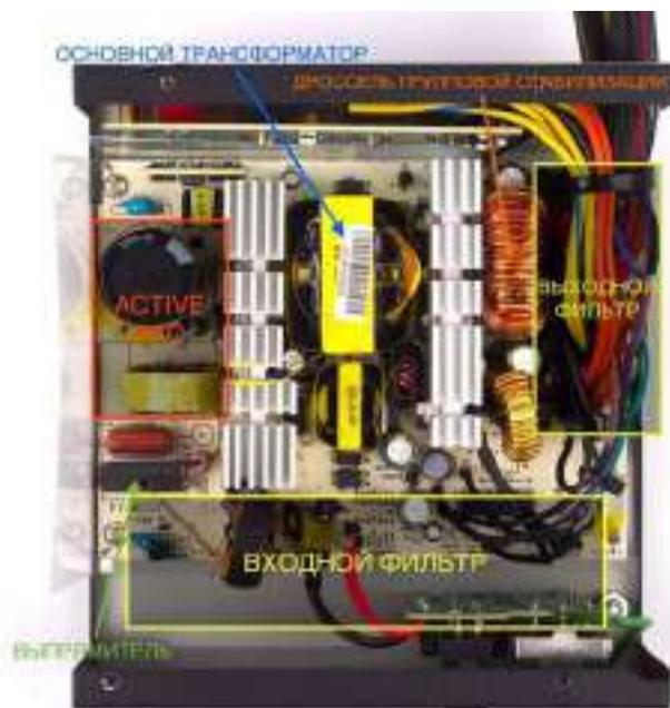
Внутреннее устройство БП (AeroCool KCAS-650M)
