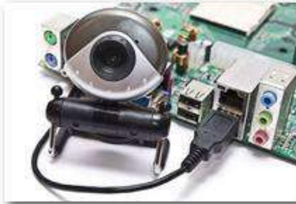
Веб камера используется как устройство для съемки видео. Она управляется через компьютер. Основная задача – общаться с другими пользователями через видео-чат, где можно видеть собеседника. Передача видеосигнала идет в режиме реального времени. Есть еще способы использования такой камеры, например, снять любительское видео в комнате.
