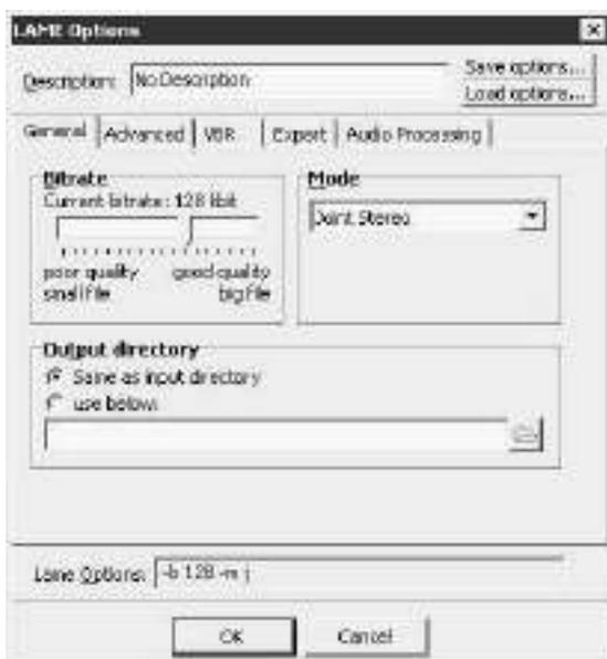
Настройка параметров Lame в программе Razor Lame
