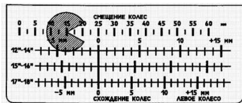
Рисунок 12 – Схема шкалы правого измерительного прибора
