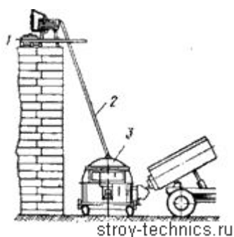
Рис. 181. Установка для приготовления, хранения и подачи горячих мастик или битума на кровлю УХМП-1 1 — раздаточная емкость; 2 — трубопровод; 3 — цистерна
