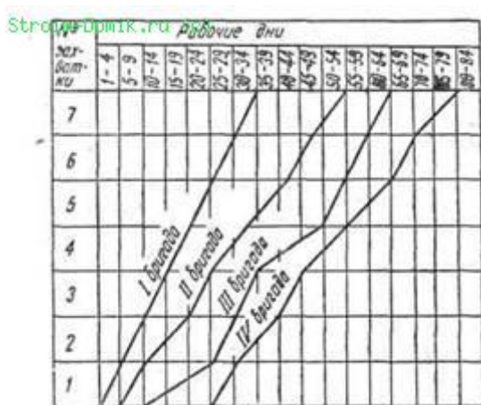
Рис. 5. График производства работ неритмичным потоком
