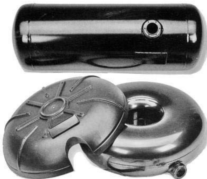
Рисунок 2.2 – Баллоны (цилиндрический и тороидаальный)
