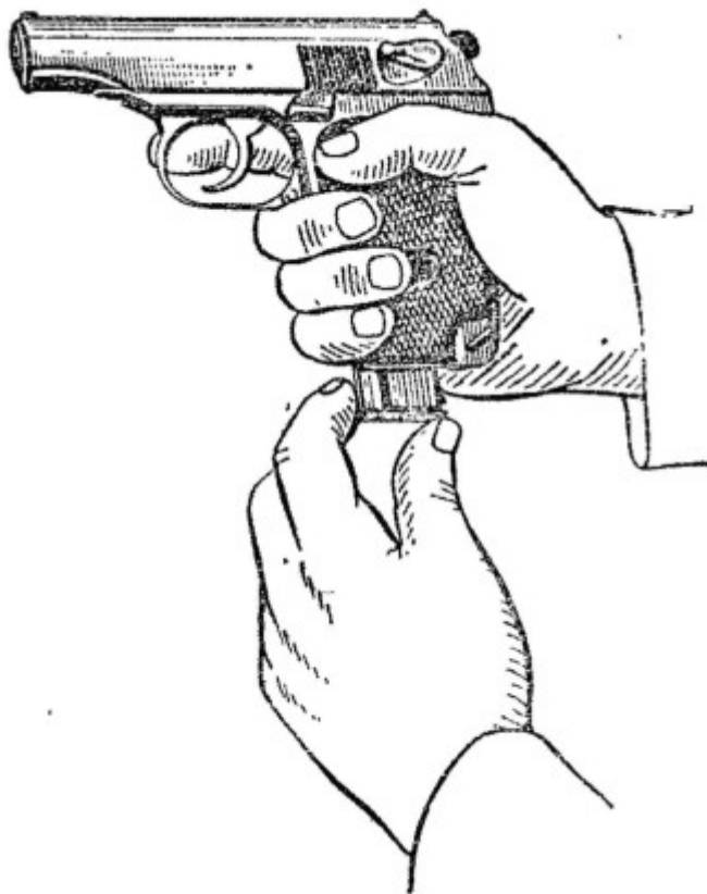
Рис. 8. Вставление магазина в основание рукоятки
