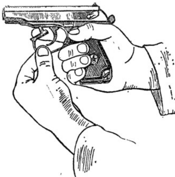
Рис. 4. Оттягивание спусковой скобы
