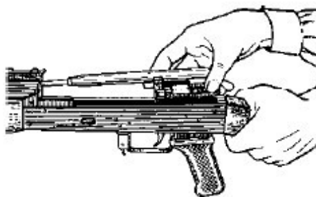
Рис. 15. Отделение затворной рамы с затвором
