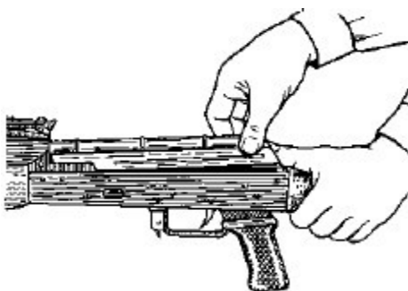
Рис. 13. Отделение крышки ствольной коробки
