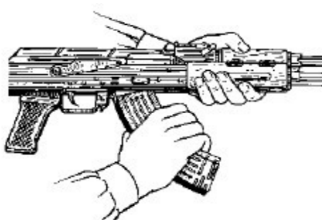
Рис. 19. Присоединение газовой трубки
