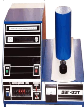
Комплект индивидуальных дозиметров типа ИД-02 (ДДНТ-02), ДВГ-02Т
