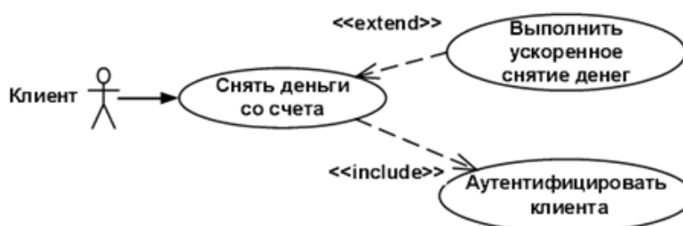
Рисунок 3.5 - Пример связи включения и расширения
