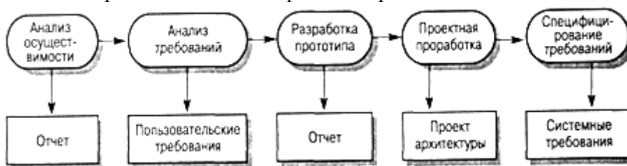
Рисунок 4.1 - Этапы процесса разработки спецификации
