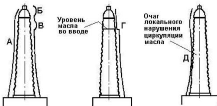
Рисунок 3 - Характер распределения температуры по высоте маслонаполненного ввода.
