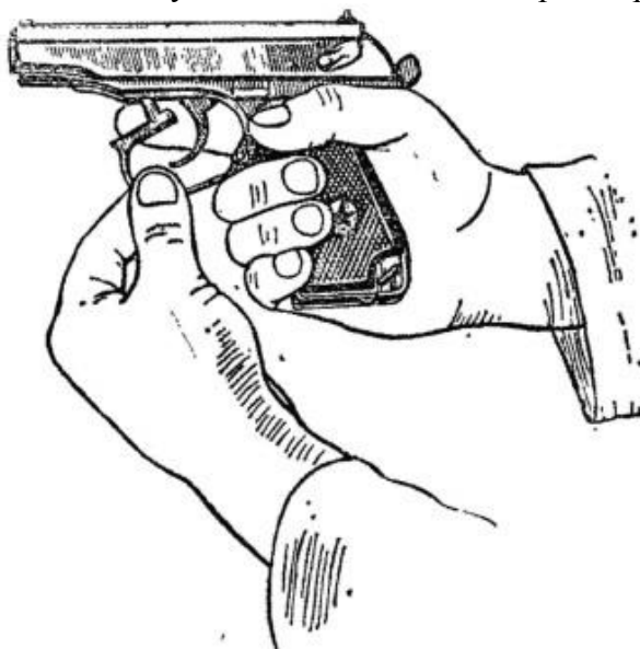
Рис. 4. Оттягивание спусковой скобы
