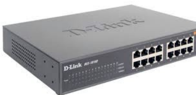
Рис. 7. Концентратор с фиксированным количеством портов
