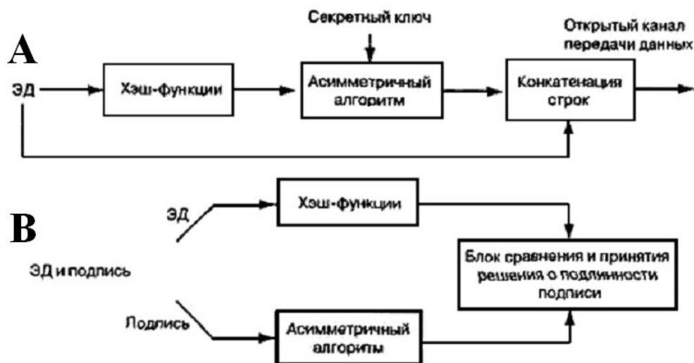
Рис.5.3. Основные методы построения схем ЭЦП. Схема 3.
